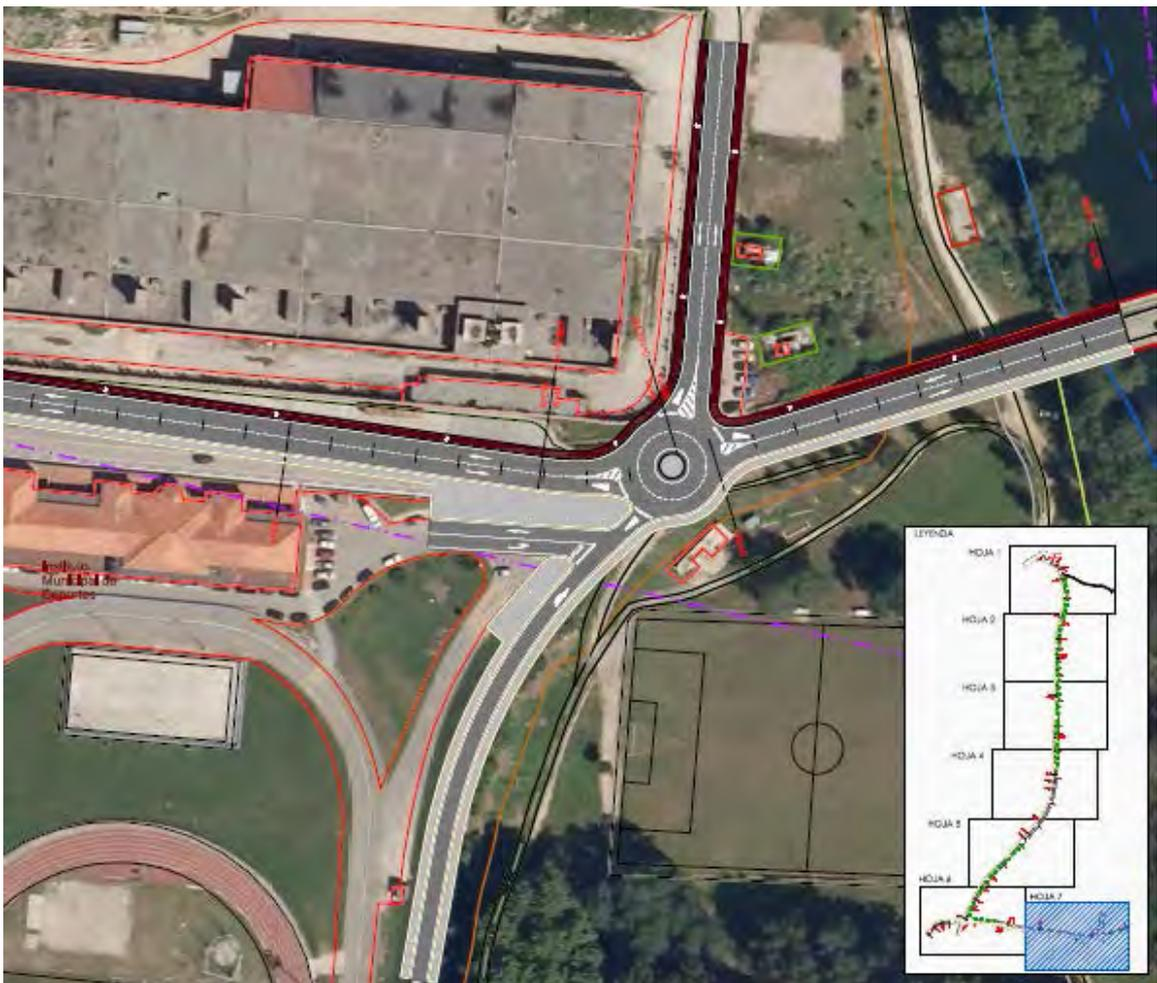
La sección cuenta con una calzada de dos carriles con una anchura total de 8 metros, mientras que la acera y la vía ciclista tienen 2 m de ancho cada una. Esta anchura es demasiado reducida para
